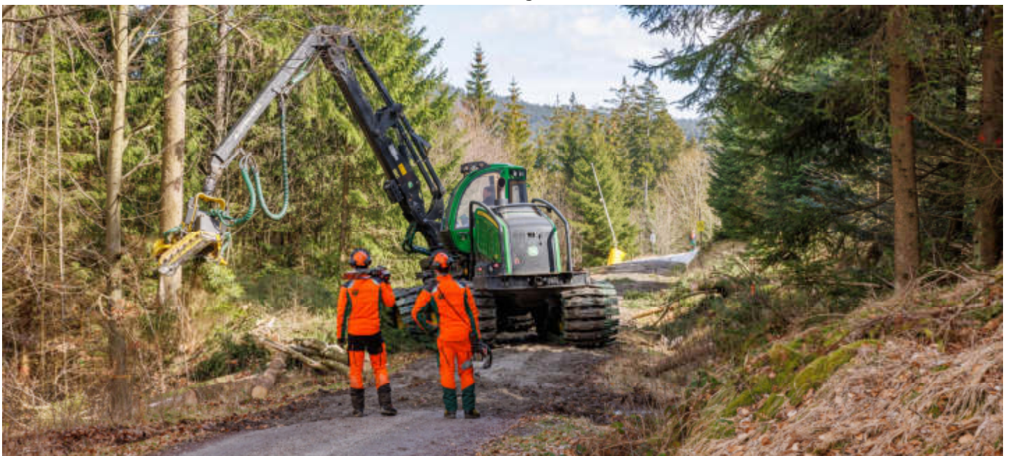
Andreas Schinner und Janis Schemm, Forstwirte bei den Bayerischen Staatsforsten, fällen gemeinsam mit einer Holzernemaschine die Bäume auf der zukünftigen Pistenanbindung an der Mittelstation
